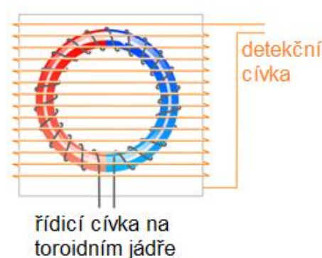
Obrázek 5: Principiální schéma fluxgate senzoru s toroidním jádrem (upraveno z [18])
